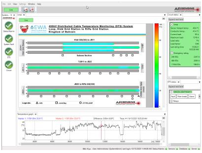
usuario (GUI) fácil de usar. Los gráficos de temperatura y las tablas de puntos calientes se encuentran disponibles fácilmente, la trayectoria de los circuitos se mapea y codifica por colores para mostrar las temperaturas de los cables e indicar cualquier cambio instantáneo. Las secciones del trayecto de los cables pueden definirse individualmente para disponer de niveles y tipos de alarma flexibles, mientras que los puntos de interés (empalmes de cables,
