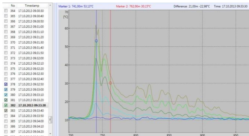
Brandversuch 2 (Benzinbrand): 5 MW ; Detektionszeit: 33 s
