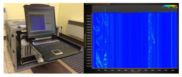
Links: Mobiles DAS-System; Rechts: Wasserfalldiagramm mit akustischen Signalen
